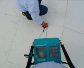
**DETECCIÓN DE VARILLAS EMBEBIDAS EN EL CONCRETO, DIÁMETRO DE LAS MISMAS Y RECUBRIMIENTO DEL CONCRETO A TRAVÉS DE EQUIPO DE ULTRASONIDO**
