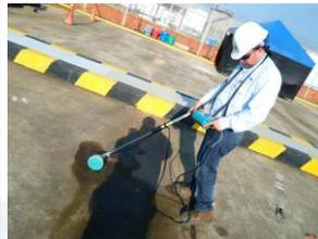
**ANÁLISIS DE CORROSIÓN DEL CONCRETO Y LAS VARILLAS QUE ESTÁN EMBEBIDAS EN EL CONCRETO**
