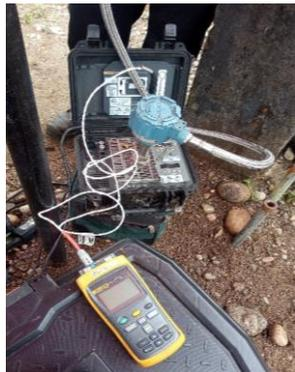
**Calibración en temperatura con trazabilidad:** Este servicio se lleva a cabo de acuerdo a instrucciones de la norma NT VVS 103 Thermometers, contact, direct reading Calibration Nordtest Method 09-1994
