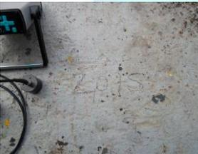
**ENSAYO DE DETERMINACIÓN DE PROFUNDIDAD DE GRIETAS DEL CONCRETO. ESPESORES DE LAS ESTRUCTURAS DE CONCRETO**
