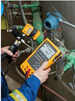
**Calibración en presión con trazabilidad:** Este servicio se lleva a cabo de acuerdo a instrucciones de la norma Guidelines on the Calibration of Electromechanical and Mechanical Manometers EURAMET Calibration Guide No. 17 Version 4.1 September 2022
